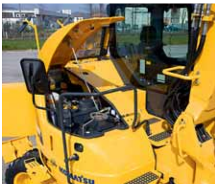
Tous les principaux points de maintenance sont aisément accessibles à partir du sol
