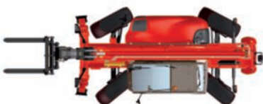
4 roues directrices pour les braquages courts sur les chantiers exigus
