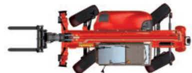
Marche en crabe pour les approches latérales et les dégagements délicats
